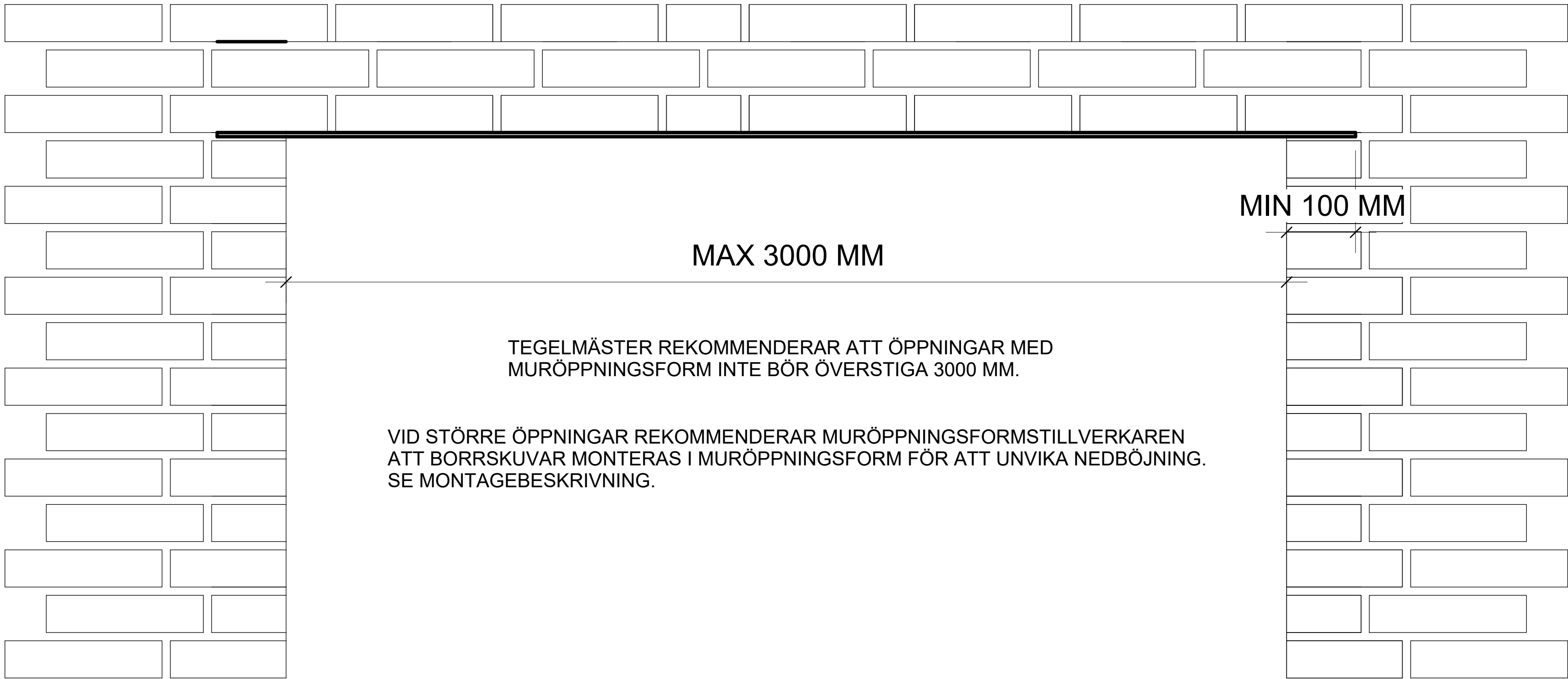
MURÖPPNINGSFROM FRONT 1 : 5 (A1)
