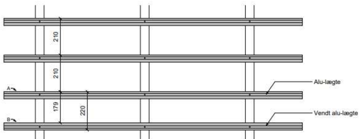
Figur 7 Utsnitt av montaget av de nedersta aluminiumläkten.
