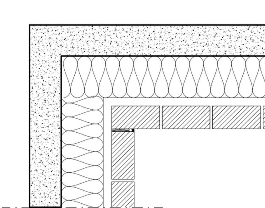
Dilatationsfog i innerhörn är ett smidigt sätt att dölja fogen på. Finns det innerhörn på fasaden försöker vi placera rörelsefogen där.
