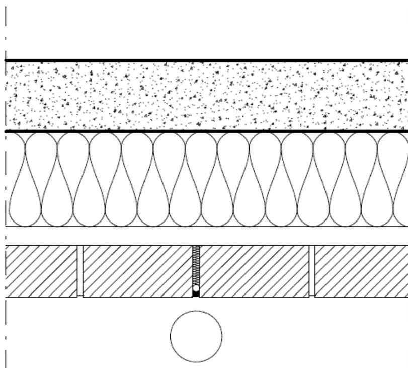
Bakom stuprör är den vanligast och det enklaste sättet att dölja en dilatationsfog på.
