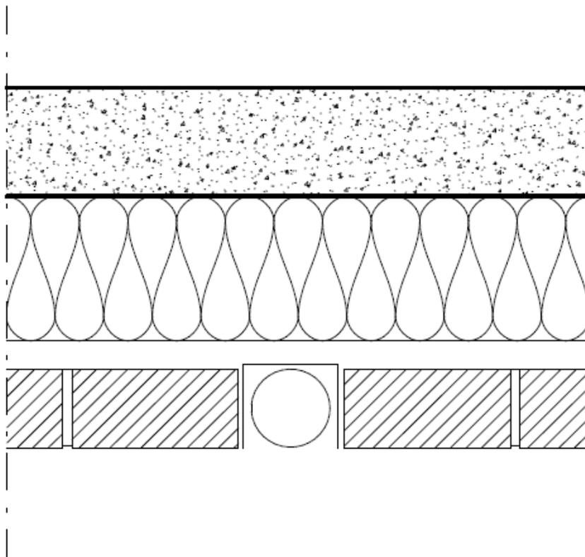
Indragna stuprör kan fungera som en "naturlig" dilfog. Tänk dock på att skapa tegelpelare ner till en sockel på var sida om stupröret. Öppningar bör med andra ord ligga minst 1 & 1/2 sten från infällt stuprör.
