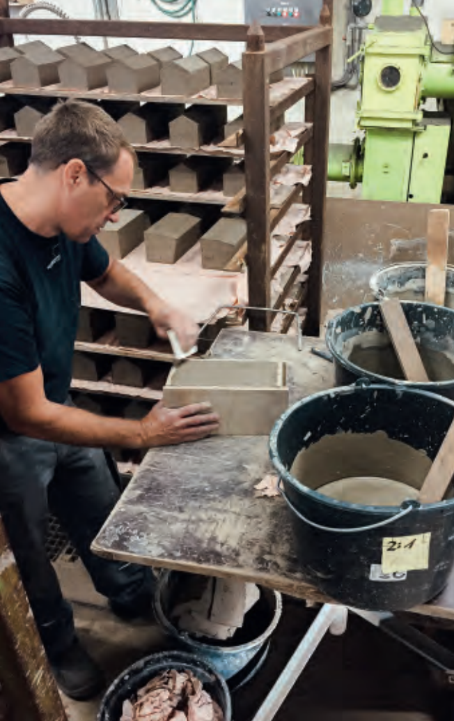
Cirka halvdelen af Petersen Tegls produktion, eksempelvis formstene til Museum De Lakenhal, håndlaves i træforme efter flere hundrede år gamle metoder.
